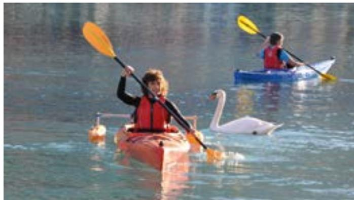
Durch die beiden Schwimmkörper auf der Seite wird das Kayak stabilisiert und ermöglicht ein selbständiges Paddelerlebnis auch für Personen, die sonst auf personale Hilfe angewiesen wären.
